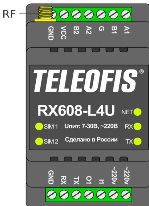
Рис. 2. Модем RX608-L4U. Вид спереди.
