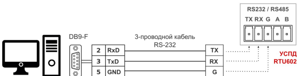
Рис. 25. Подключение УСПД RTU602 к ПК по интерфейсу RS-232.
