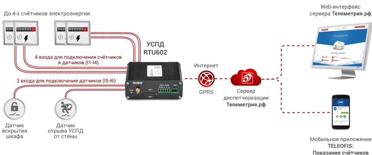
Рис. 8. УСПД RTU602 в системе учёта электроэнергии.
