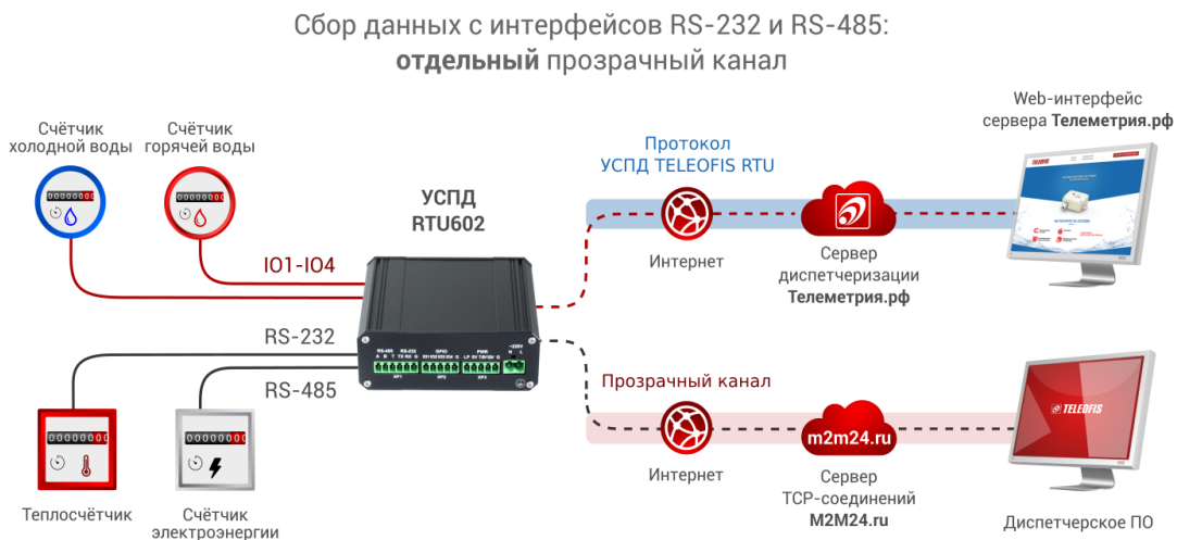
Рис. 13. Сбор данных с последовательных интерфейсов в отдельном прозрачном канале.
