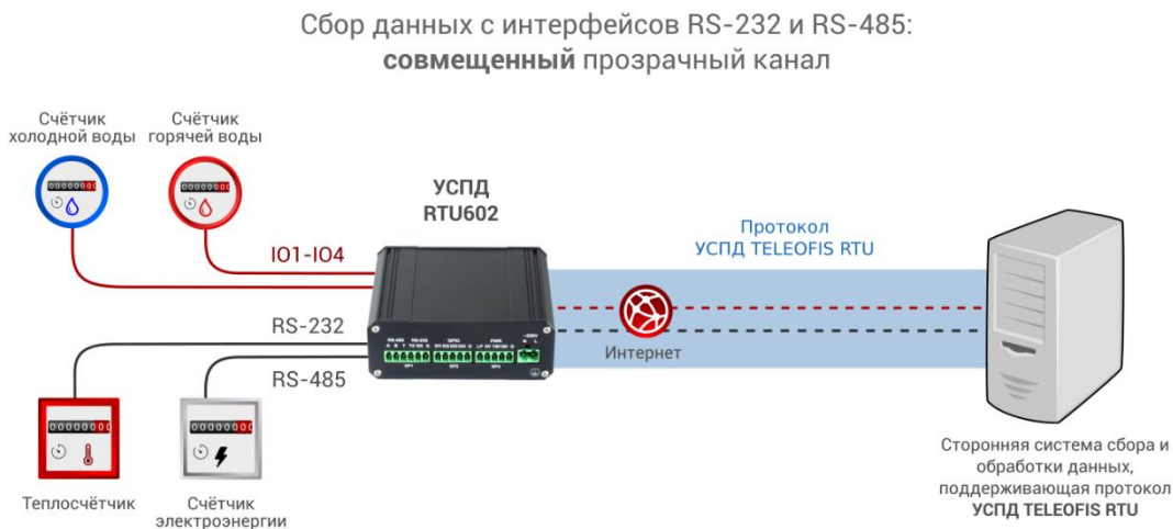
Рис. 14. Сбор данных с последовательных портов в совмещенном канале.
