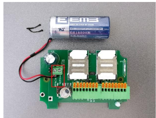
Рис. 4. Подключите новую батарею к УСПД.
