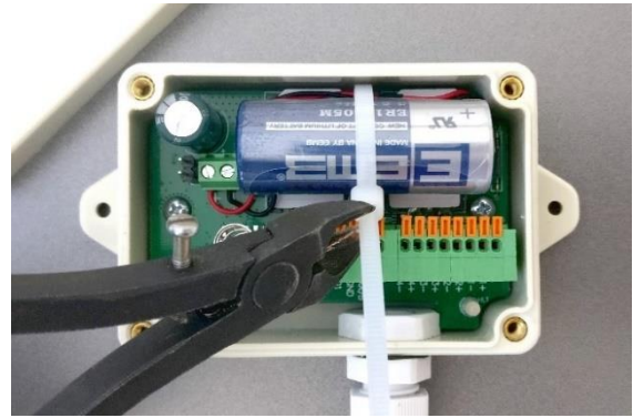
Рис. 6. Закрепите батарею стяжкой на плате.
