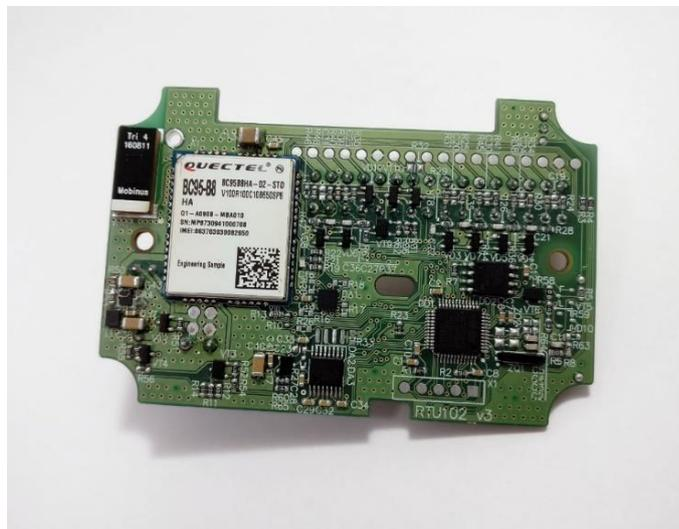
**LTE NB-IoT** — технология низкоскоростной беспроводной передачи данных с использованием узкополосной передачи радиосигнала в рамках выделенного LTE или GSM диапазона. Технология разработана для применения в решениях так называемого Интернета вещей, где огромное количество устройств обмениваются небольшими объемами данных, и обеспечивает низкоскоростную, но надёжную и бесперебойную доставку данных.
